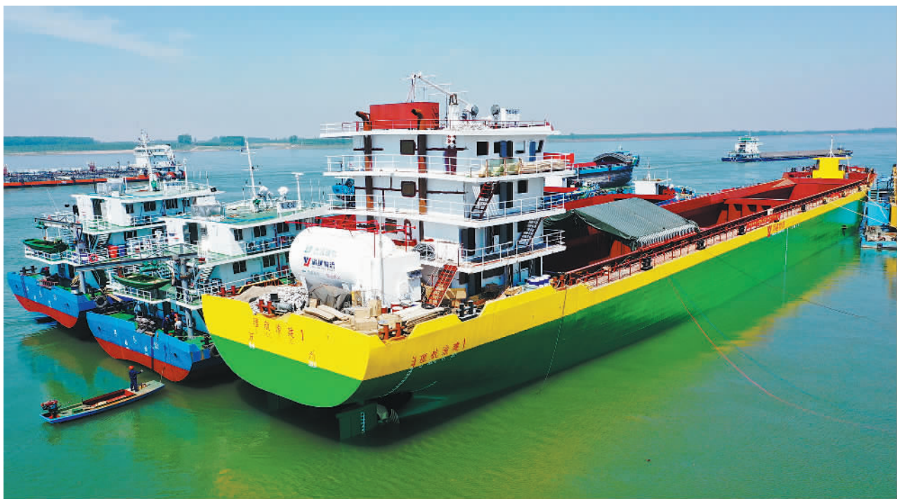
5月6日，绿色智能标准三峡130型散货运输示范船“航航渝建1号”，在湖北宜昌鑫汇船舶修造有限公司下水舾装测试。该示范船长度为130米，平时采用柴油、液化天然气混合推进，在航行至三峡船闸等关键水域时，可采用全电力推进，实现零排放。
