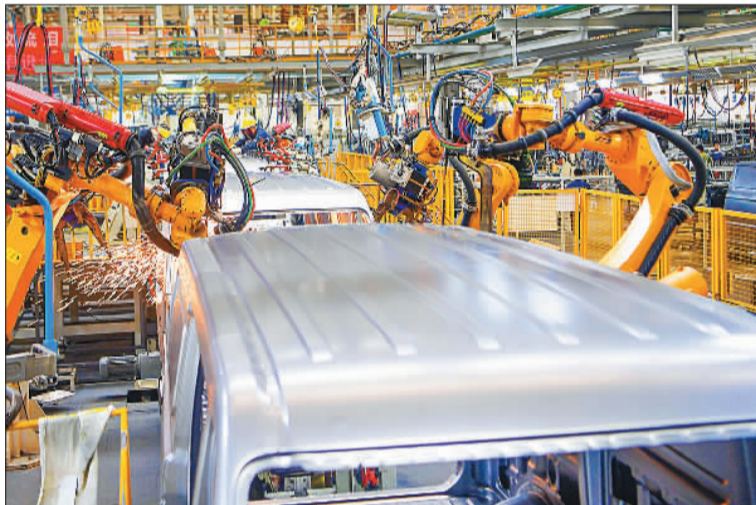
▼位于赣州经开区新能源汽车科技城的凯马汽车制造有限公司赣州分公司,机械手在焊接汽车车架。目前,赣州经开区已成为集“整车+零部件+研发+检测+汽车文化”全产业链发展的工业集聚区。 刘青摄
