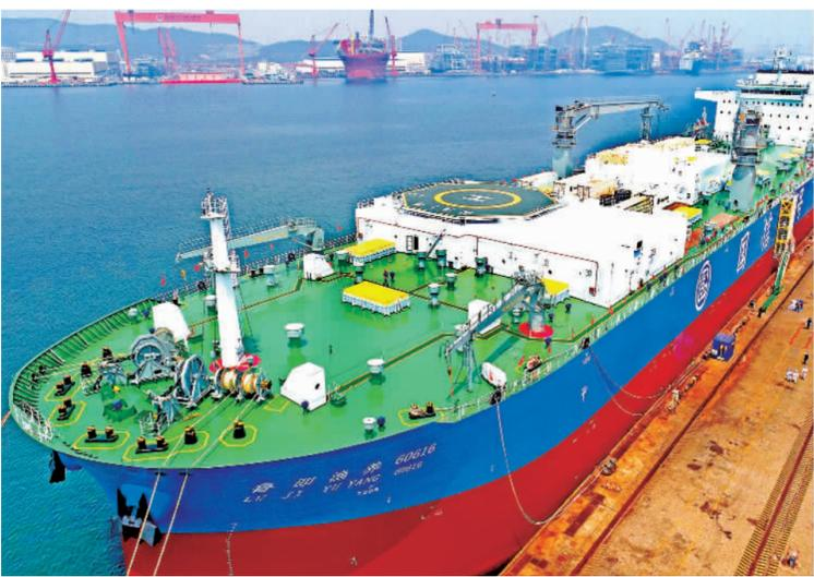
5月20日，全球首艘10万吨级智慧渔业大型养殖工船“国信1号”在中国船舶集团青岛北海造船有限公司交付运营。“国信1号”船长249.9米，排水量13万吨，载重量10万吨，设15个养殖舱，养殖水体近9万立方米，以“船载舱养”模式开展大黄鱼、石斑鱼、大西洋鲑等名优鱼种养殖，设计年产高品质鱼类3700吨。
