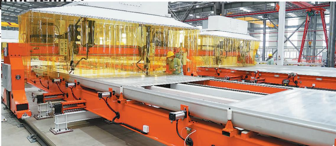
6月9日，江西日菱车业有限公司轻量化商用车铝合金车厢生产线，工人正在进行铝合金板下料作业。依托铝合金产业和汽车产业基础积淀，目前江西已初步形成轻量化铝合金商用车完整产业链条。(中经视觉)
