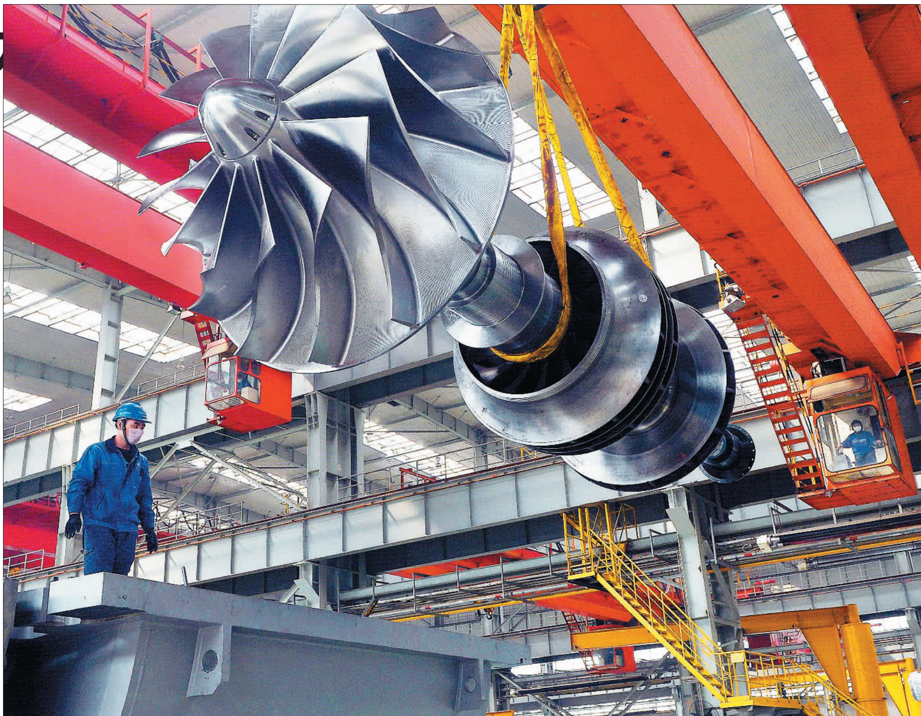
▲沈阳鼓风机集团总装车间员工在装配产品核心部件。该集团在替代进口、解决“卡脖子”的关键技术方面获得重大突破，极大地保障了国家能源安全。 本报记者 孙潜影摄
