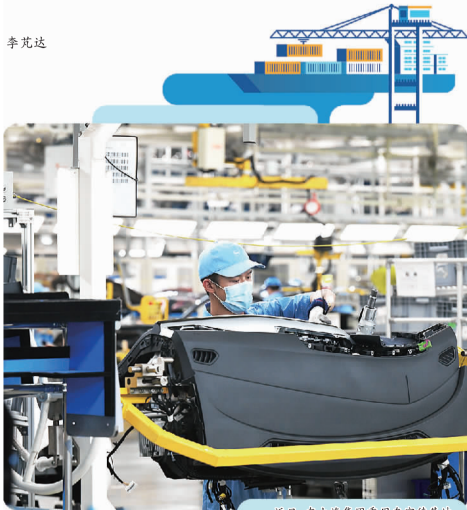
近日,在上汽集团乘用车宁德基地总装车间,工人装配汽车仪表中控。 王旺旺摄(新华社发)
