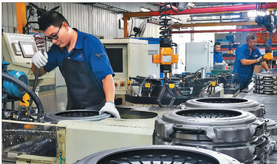
▼东北工业集团长春一东离合器股份有限公司，员工在自动化装配线上组装重卡离合器产品。长春一东坚持技术创新，多项技术填补国内空白。 本报记者 李己平摄
