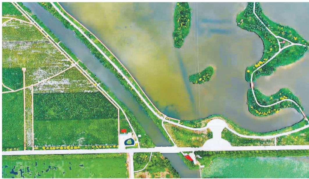
7月16日,山东阳谷狮子楼街道森泉湿地公园水清岸绿,景致宜人。该公园采用“潜流湿地+表面流湿地+河道走廊湿地”工艺,深度净化中水,日最大水处理量7万立方米。近年来,当地多措并举开展农村生态湿地保护与恢复治理,建设乡村生态宜居环境。郭殿波摄(中经视觉)
