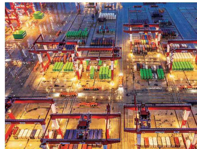
在广州港南沙港区四期项目,岸桥、轨道吊和往来穿梭的橙色无人驾驶智能导引车(IGV)在智能控制系统的指挥下正有序进行作业。 邱新生摄(中经视觉)
