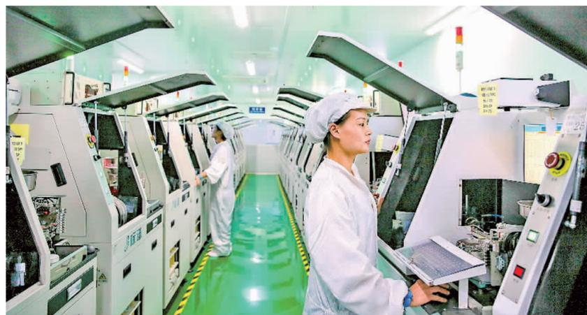
位于江西省瑞昌市科技园内的江西瑞晟光电科技有限公司是一家从事LED光电半导体器件及应用产品研发、生产及销售的企业。近年来,公司采用先进的传感技术、智能控制系统等打造智能化车间,实现生产过程数字化、智能化,大幅提高了生产效率和管理水平。图为江西瑞晟光电科技有限公司生产车间内,工人在操作分光设备。
