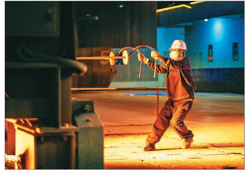
▼位于安徽省马鞍山市的宝武马钢长材事业部炼钢生产线,员工进行钢水取样测温。张明伟摄(中经视觉)
