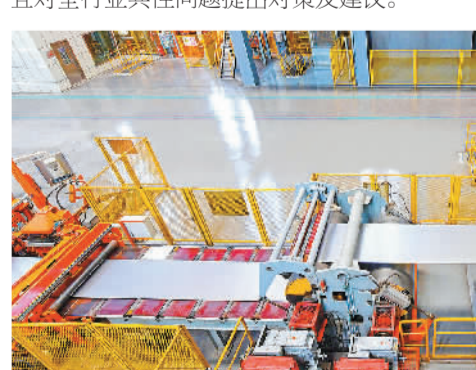
河钢集团正在应用低碳工艺技术组织生产高等级表面质量的冷轧汽车钢产品
