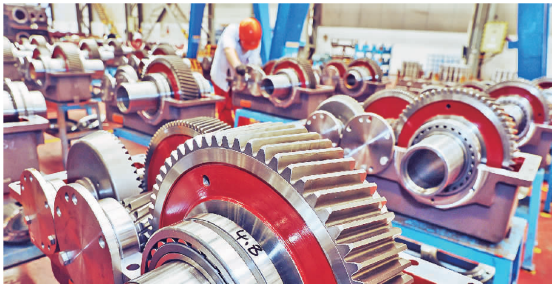
7月份,上海振华重工集团(南通)传动机械有限公司海上风电安装船抬升减速机单月产出103套,海上风电安装船抬升减速机焊接完成126根。目前,该公司正在加紧完成山东日照港、天津港、广西钦州港等一批港机大车类减速机项目订单。图为工作人员在装配车间进行海上风电安装船抬升减速机装配。
