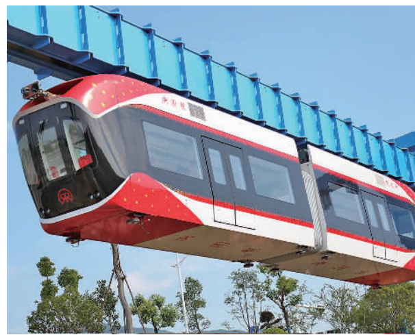
世界首条永磁磁浮轨道交通工程试验线“红轨”。(资料图片)
