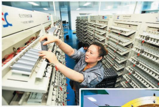
贵州省贵阳高新区一家新能源制造企业员工对锂电池产品进行性能检测
