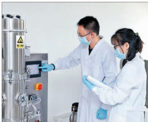
华北制药新药品制剂所研发人员正在操作制粒包衣一体机，进行湿法制粒
