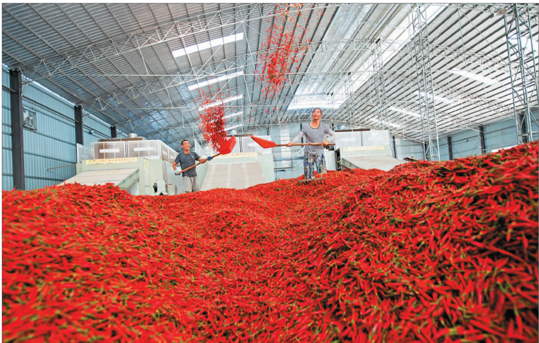
工人将收购的鲜辣椒铲上烘干线。遵义市中国辣椒城现有13条烘干线，满负荷运转时每日能烘干鲜辣椒130吨左右。胡志刚摄（中经视觉）
