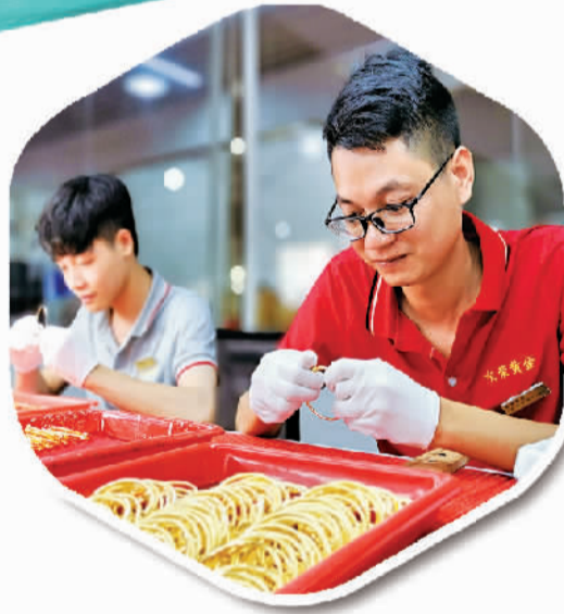
在广西黄金珠宝产业园内,一家珠宝生产企业工人在检查手镯的压光质量。
