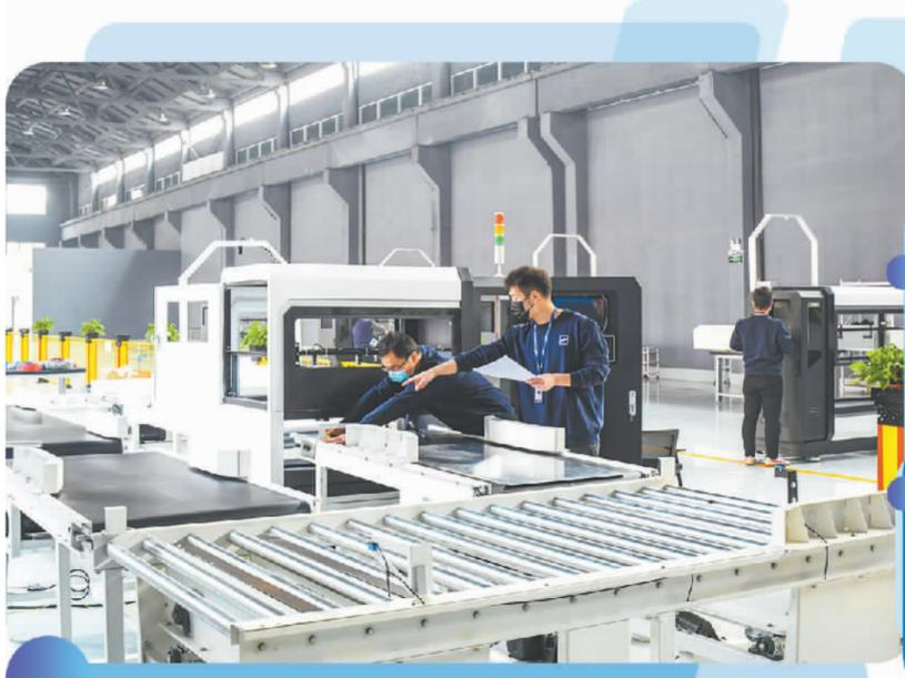
深兰科技公司的技术人员在调试计算机视觉工业检测标准化装备。
