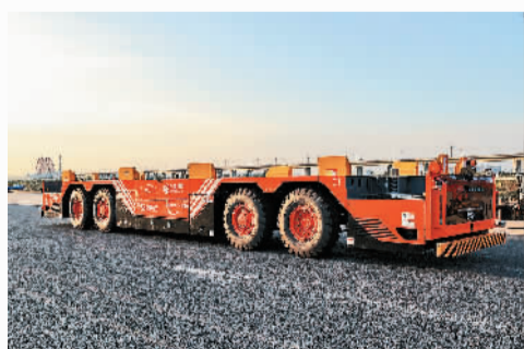
合肥港通过智能网联信息化改造,纯电动无人驾驶水平运输车现身港区
