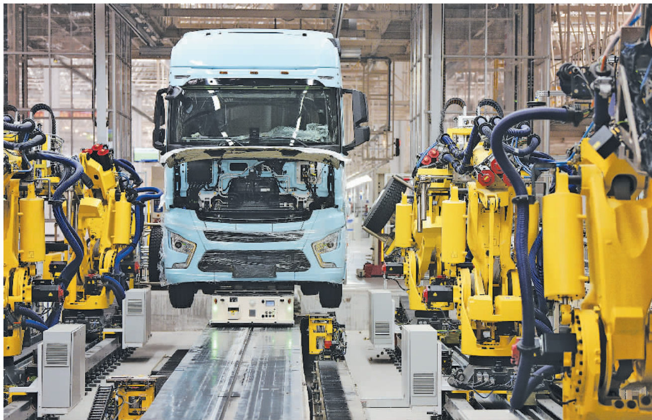
在陕汽重卡扩能项目现场,一辆重卡在汽车总装生产线轮胎自动化装配拧紧无人工作站进行装配。新华社记者 刘 满摄
