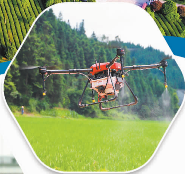
贵州强化农业科技支撑,提高农业质量效益。图为植保无人机进行水稻病虫害飞防作业
