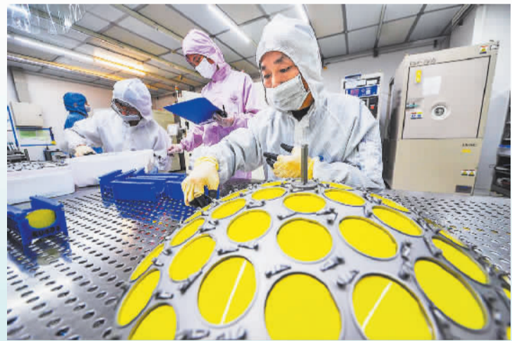
晶能光电LED芯片金属蒸镀
