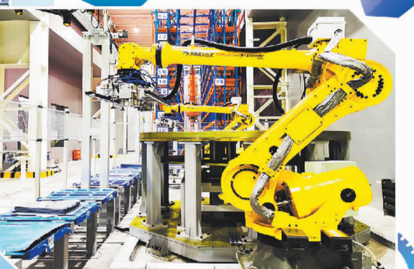
哈电集团电机公司智能叠片车间机器人自动叠片生产线。本报记者 吴浩摄
