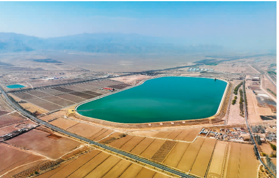
3月29日,俯瞰宁夏银川西夏水库。西夏水库主要承担银川都市圈城乡西线供水工程的水源调蓄功能,水库面积相当于300个标准足球场大小,可满足银川33天不间断供水,有力保障城市供水安全。袁宏彦摄(中经视觉)
