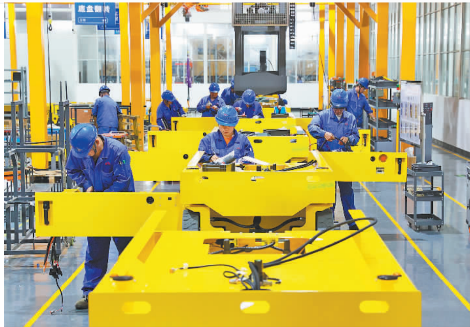
近日，在位于浙江省诸暨市陶朱街道的浙江露露重工有限公司生产车间内，技术人员正在安装调试剪叉式登高车。剪叉式登高车可代替吊篮、脚手架等传统登高机械，提高高空作业安全性及作业效率，主要应用于建筑、仓储物流、石油化工、船舶制造与维护等领域。
