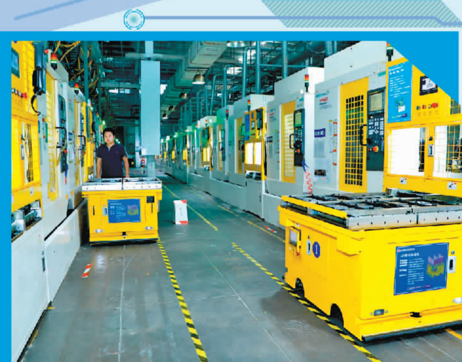
金振源公司车间内,自动导引运输车在开展作业。冯 阳摄(申经视觉)
