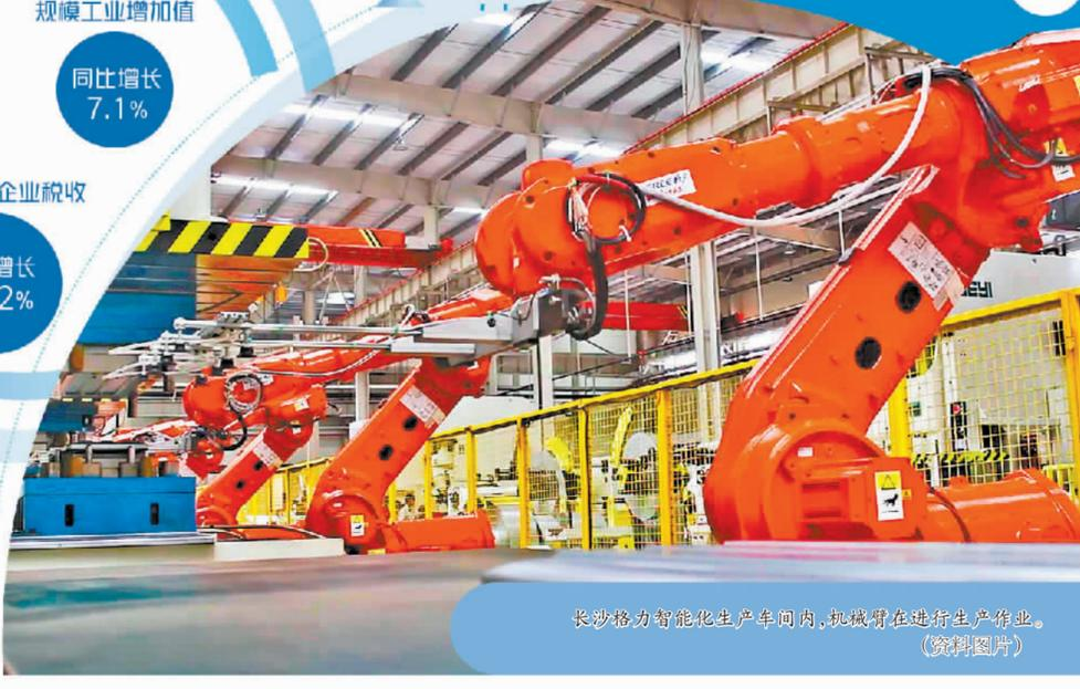
长沙格力智能化生产车间内,机械臂在进行生产作业。(资料图片)
