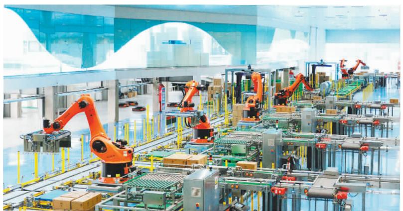
伊利液态奶生产线上的库卡机械手在码垛作业。
