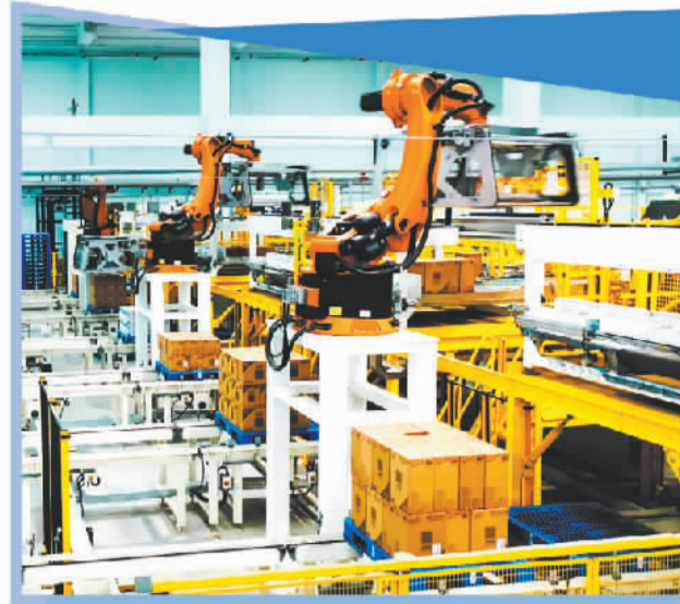
图中为中轻长泰自主研发的全自动机械手码垛系统。(资料图片)
