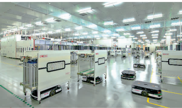
在位于浙江省东阳市的横店东磁太阳能电池片未来工厂,AGV(自动导向车)穿梭在各个生产单元之间,承担了物流搬运的工作。 胡肖飞摄(新华社发)
