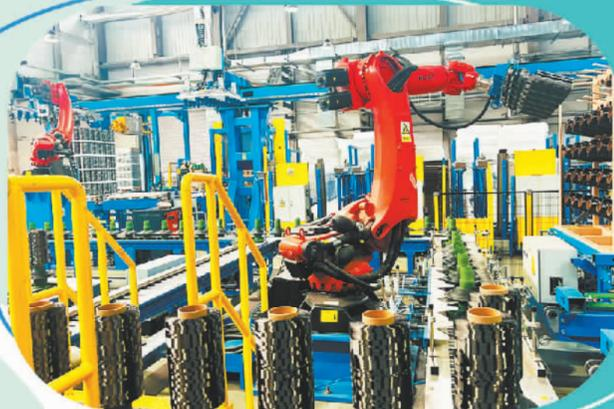
工业机器人正在将碳纤维丝筒密封装箱。
