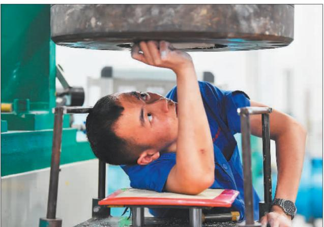
▲位于景德镇高新区的江西奥福精细陶瓷有限公司生产车间，员工正在调试蜂窝陶瓷载体制造设备。
