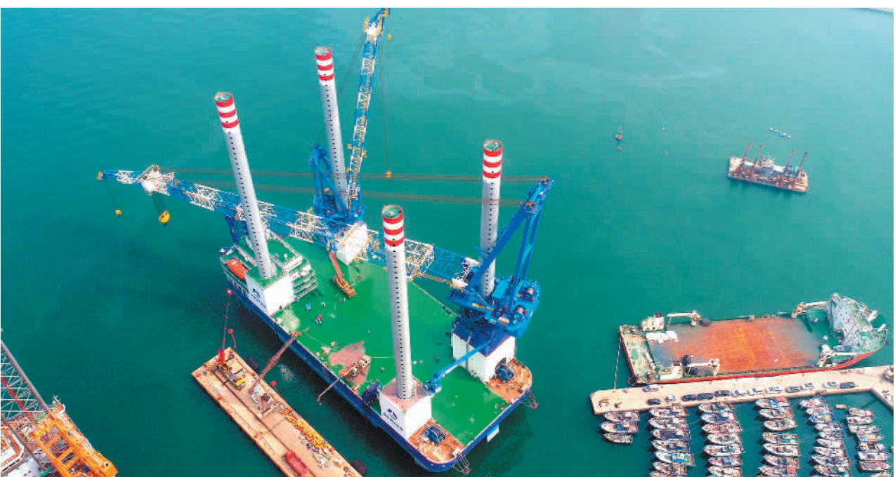
7月25日，“华夏金租神大01”号1200吨自升式海上风电安装平台在山东青岛交付。该平台是目前国内作业水深最大、主吊机吊最高的圆柱形桩腿风电安装平台，能够满足国内最大海上风机的存放安装需求。张进刚摄(中经视觉)
