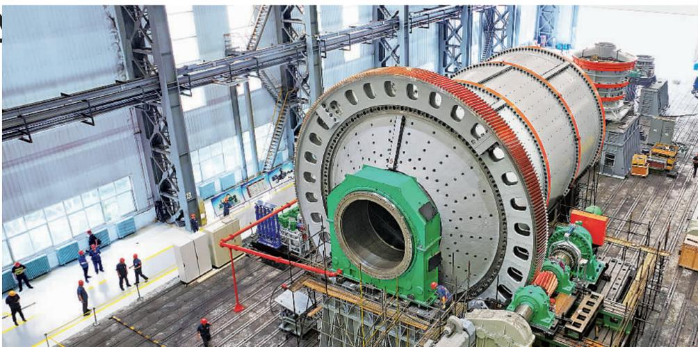
8月15日,中信重工自主研发的直径8.2米、长12.7米溢流型球磨机在河南洛阳完成工厂试车并交付客户。该设备是目前“中国造”首台套最大的球磨机,将出口应用于中资矿企在非洲加纳的首个金矿项目。(陈安摄(中经视觉))
