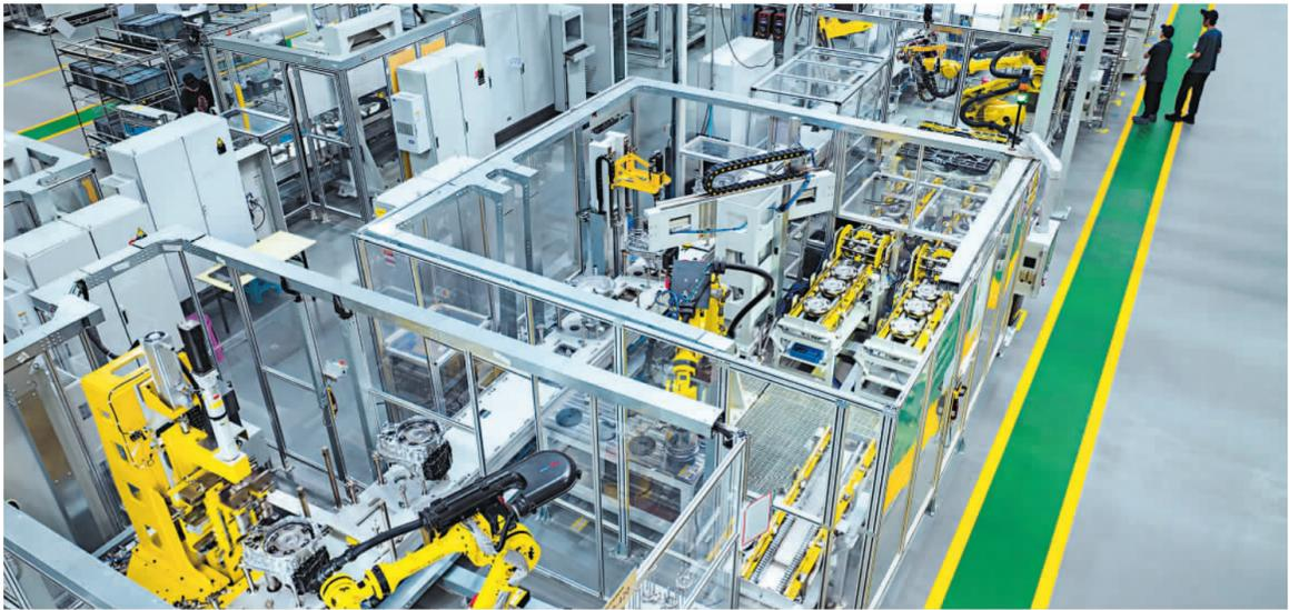
10月9日，在安徽省芜湖市繁昌经济开发区孚硕汽车动力系统有限公司8AT自动变速箱智能化生产流水线上，技术工人和智能机械臂正在生产作业。8AT自动变速箱由该公司自主研发并生产制造，拥有完整的知识产权。肖本祥摄(中经视觉)
