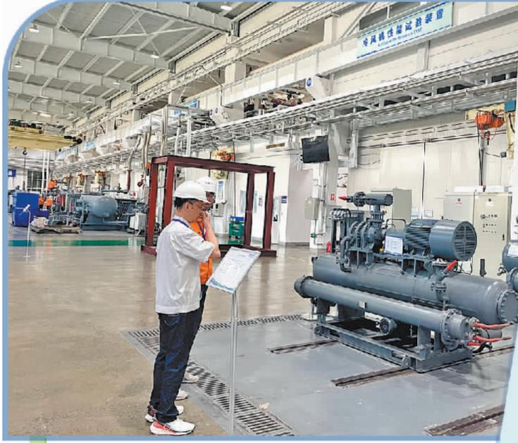
图为位于大连金普新区的冰山集团冷风机性能试验装置。
