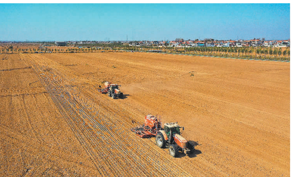
10月30日,在河南省周口市淮阳区15万亩高标准农田示范区,两台大型北斗导航精准播种机正在播种小麦。这两台精准播种机采用北斗导航进行智能化播种,可自动调整种植密度、行距、播深,最大限度地提高小麦的产量和品质。 杨正华摄(中经视觉)
