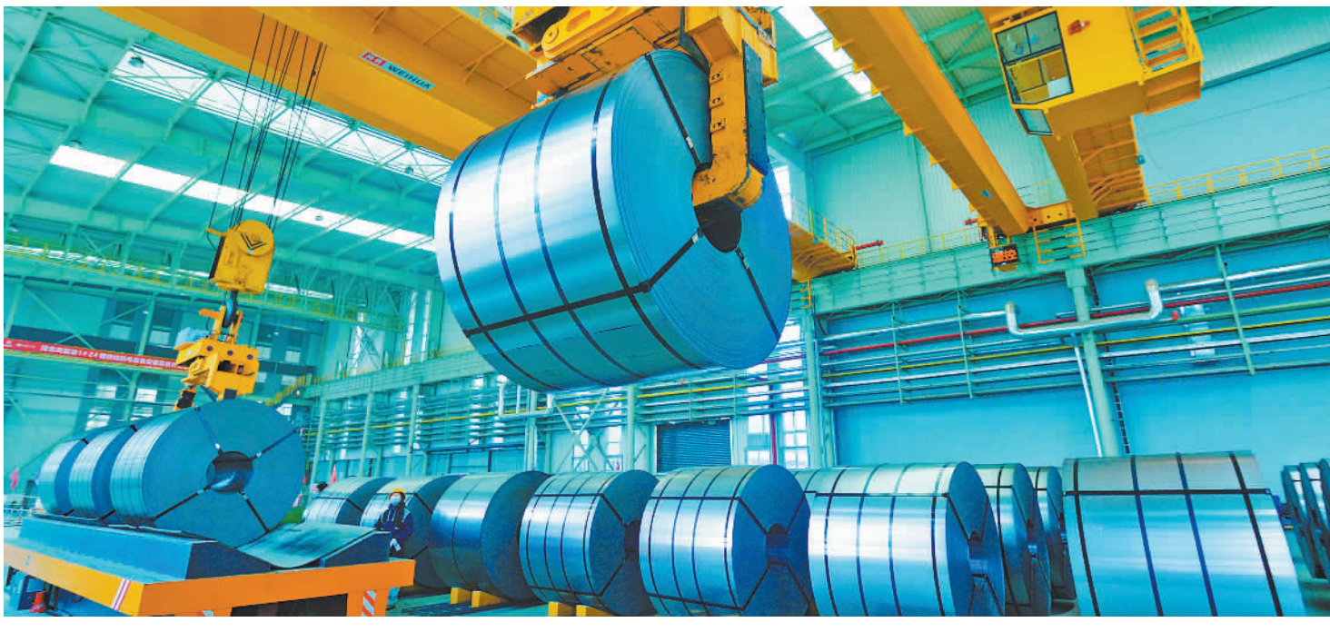
11月20日,在河北省承德市双滦区美富溢钒钛高端数字化系列冷轧生产制造项目车间,智慧天车正在吊运冷硬板。近年来,当地围绕钒钛新材料产业展开布局,打造钒钛新材料产业园,产品广泛应用于汽车、家电等领域,助力区域经济高质量发展。孙占军摄(中经视觉)
