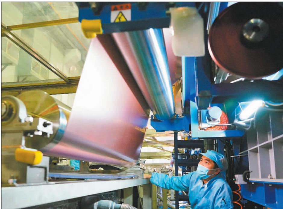
▲铜陵有色铜箔公司生箔车间，员工正在检查铜箔表面外观质量。铜箔是锂电池制造中的重要基础材料，广泛应用于新能源汽车、消费电子等领域。
