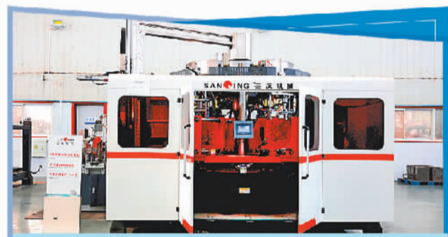
三庆机械自主研发的六模高速旋转吹塑机。杨晨摄(中经视觉)
