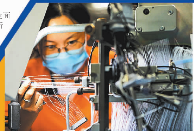
河北鹤煌网业股份有限公司的技术人员在对造纸网进行插接处理。
