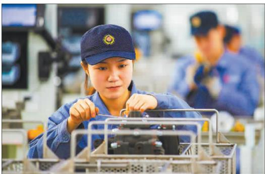
▲大秦铁路车辆制动钳工精检细修，确保制动机性能良好。
