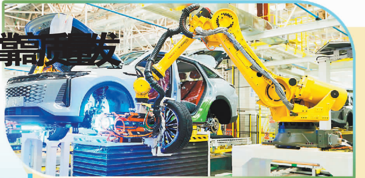
山东省青岛市即墨区一家汽车制造企业的总装车间,智能机械臂在安装车轮。 梁孝鹏摄(中经视觉)
