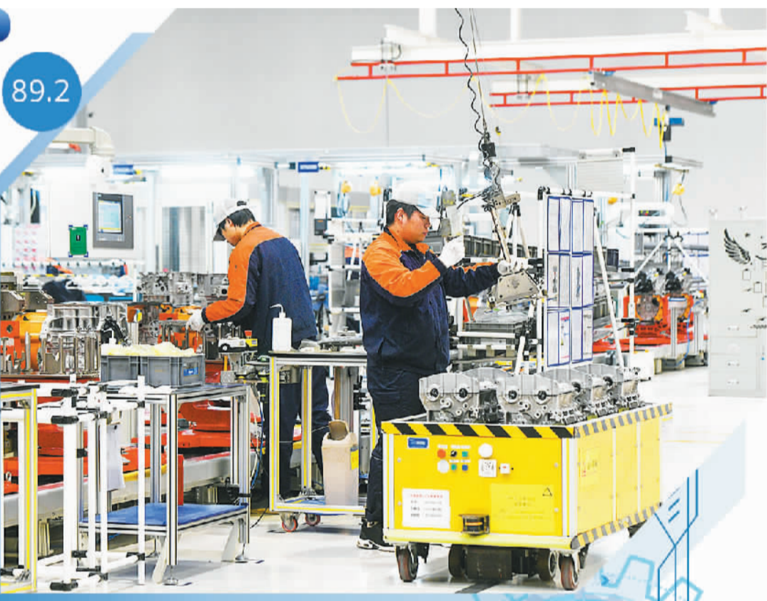
浙江省义乌吉利动力总成发动机制造工厂内,技术人员在智能化生产车间装配混动汽车发动机。
