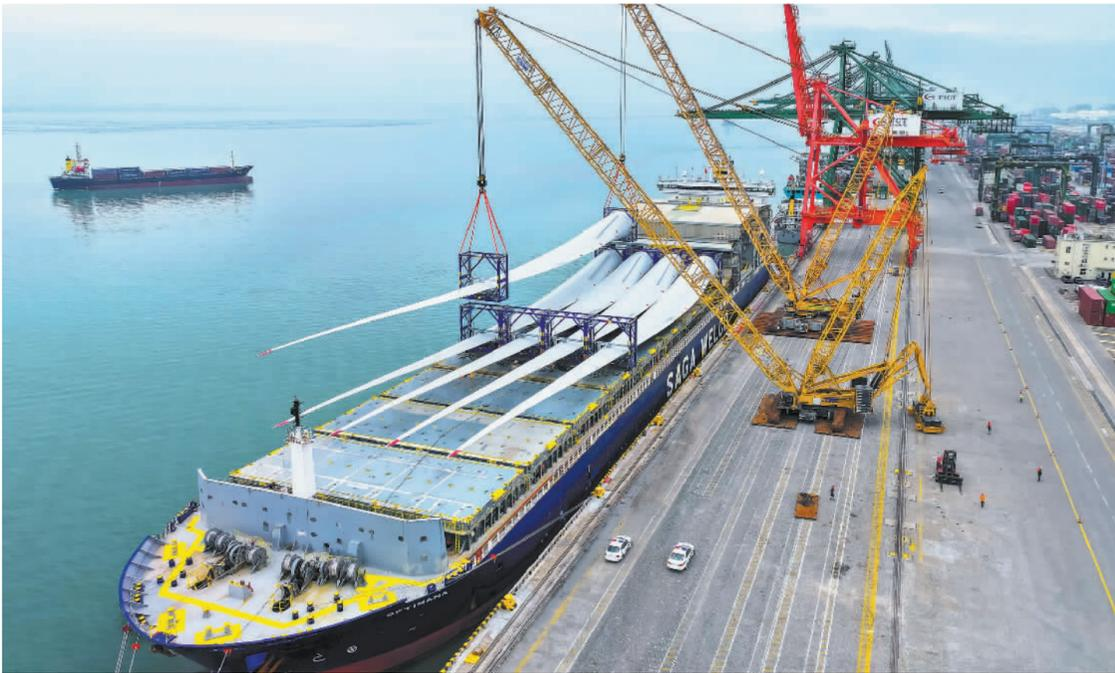
3月22日,福建省福州港江阴港区,全球量产最长108米大功率风电叶片正依次装载上船,准备运往新加坡。近年来,位于福清江阴港城经济区的三峡海上风电国际产业园集聚多家风电龙头企业,形成结构件、电机、叶片、整机等完整产业链,助力海上风电装备制造加快发展。
