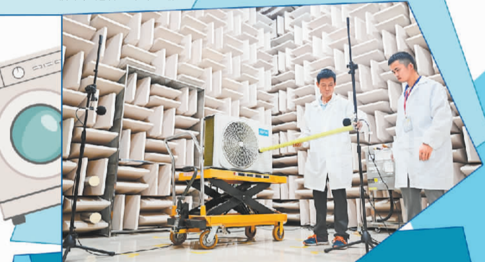
广西柳州市柳江区智能家电产业集聚区里，一家空调企业的技术人员在实验室里对即将上市的产品进行噪声测试。
