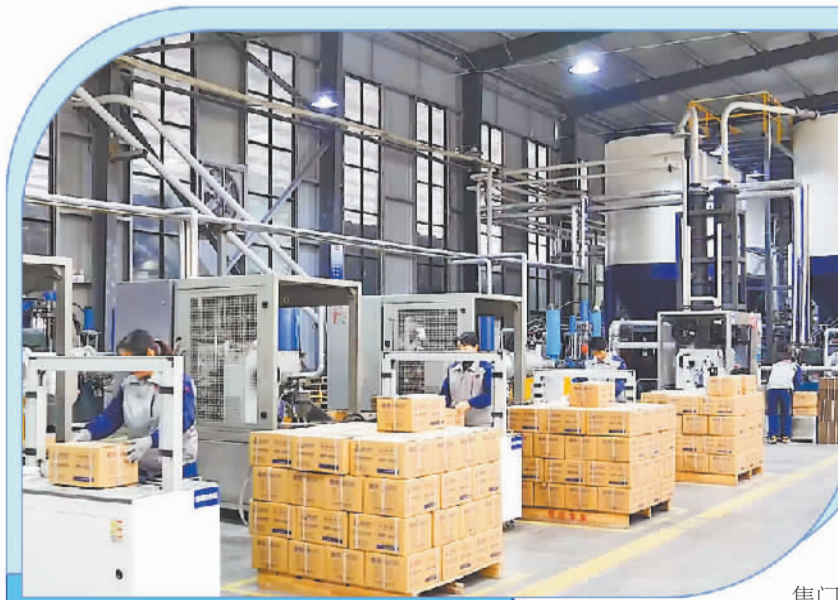
在君邦新材料科技有限公司生产车间,工人正分装打包硅密封胶。黄卓摄
