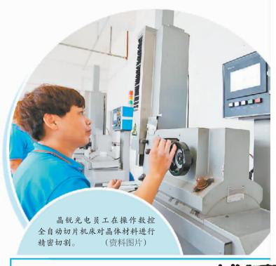
2米多高的晶体生长设备中,一 个个晶棒在1000多摄氏度的高温环 境里,完成接种、放肩、等径、收尾、提 晶等工艺步骤。大约15天后,晶棒 "长成",再经过切割、研磨、抛光、清洗 等多道工序,变成一张张小薄片。
