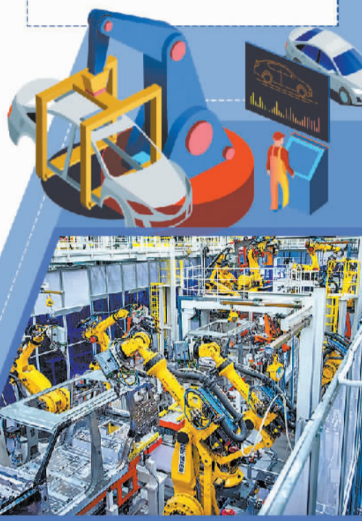
在安徽省芜湖市奇瑞新能源爱咖生态科技有限公司新能源汽车生产车间里,工业机器人进行焊接作业。 肖本祥摄(中经视觉)
